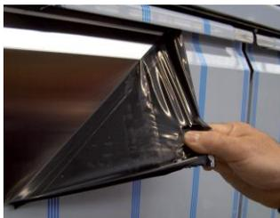
Antes de la puesta en marcha y de la carga de producto en el aparato, debe retirar la capa de plástico protectora que envuelve el mueble y limpiarlo por completo. Si quedan restos de adhesivo, han de ser eliminados con alcohol. Se recomienda limpiar todas las superficies de acero inoxidable del aparato con jabón suave y agua templada. Tras la limpieza ha de hacerse un aclarado con abundante agua y secarse con un paño suave.
