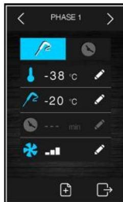
El ciclo personalizado se pone en marcha y activa la primera fase, que por defecto es una fase de sonda. Es posible cambiar la fase de la sonda a una fase controlada por tiempo y establecer los puntos de ajuste relativos.
