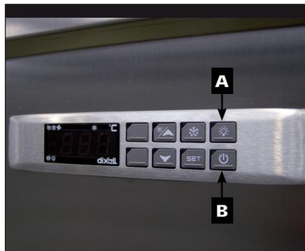
Conectar el interruptor de puesta en marcha ON/OFF (B); (Según modelos de panel de mandos). El interruptor se iluminará y oirá el arranque del motor con retardo de 1 minuto.
