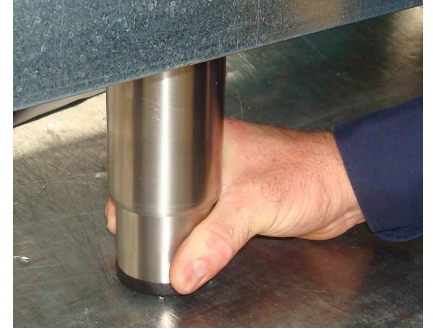
Ajuste las patas para nivelar la unidad
