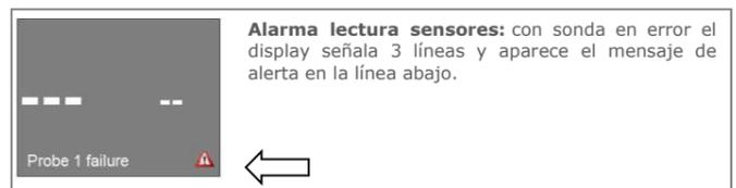
**Alarma lectura sensores:** con sonda en error el display señala 3 líneas y aparece el mensaje de alerta en la línea abajo.
